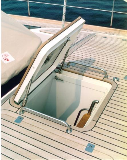
Geräte Type GET2/ GET3/ GET4 werden auf Yachten zum Öffnen und Schließen von Fenster und Türen, sowie zum Verstellen von Tischen und Monitorbefestigungen eingesetzt.
